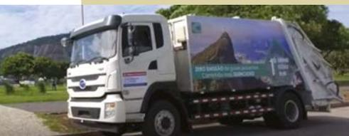
O primeiro caminhão 100% elétrico destinado à coleta e compactação de lixo do Rio de Janeiro começou a operar no último dia 20 de março. O veículo tem PBT técnico de 21 toneladas na versão 4x2 e autonomia estimada de oito horas de operação por recarga. Abastecido com energia elétrica oriunda de processamento do lixo, fecha um ciclo de trabalho totalmente sustentável. O modelo escolhido pela Clean Ambiental (Fone: 21 3104.2992) foi o BYD eT8A. Alimentado por uma bateria de
